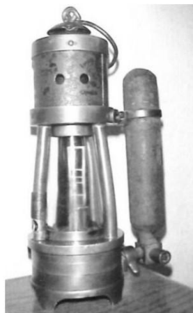
Lampă de siguranță Clowes cu hidrogen
